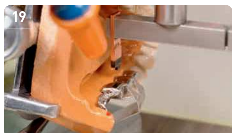
19 Процесс искровой эрозии после достижения заданной глубины окончен. Продолжительность эродирования примерно 20 минут (CoCrMo)
